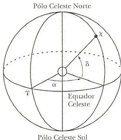
Figura 3.4. Coordenadas Equatoriais. A ascensão reta  $\alpha$  é contada a partir do ponto  $\gamma$  ( $\gamma$ ), enquanto que a origem das declinações ( $\delta$ ) é o equador celeste.
